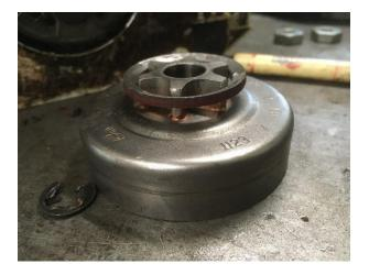
Une fois la rondelle soudée, la soudure interférait avec la rondelle qui retient l'embrayage. J'ai donc dû usiner la soudure.
